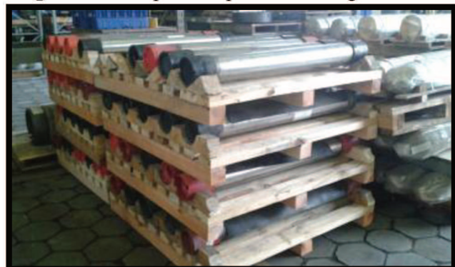
Figura 12 – Dispositivo para armazenagem de tubos
