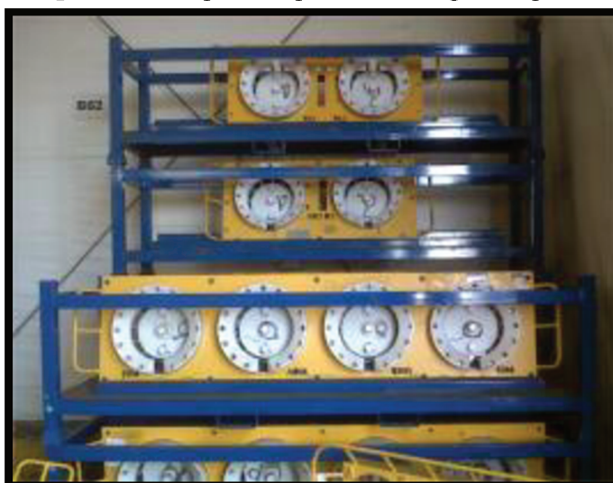
Figura 13 – Dispositivo para armazenagem de painéis
