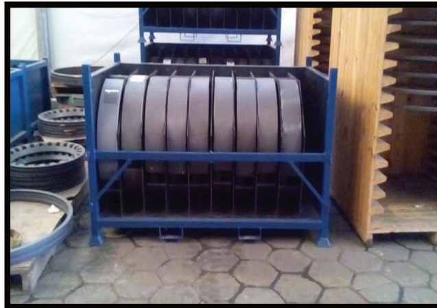
Figura 11 – Dispositivo para armazenagem de anéis
