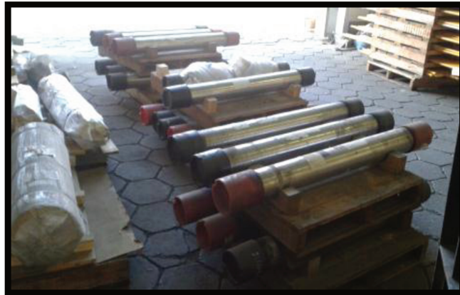
Figura 9 – Armazenagem de tubos em pallets
