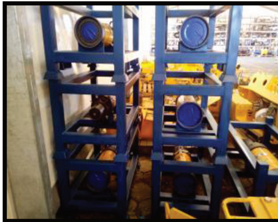
Figura 7 – Dispositivo de armazenagem do material montado na produção
