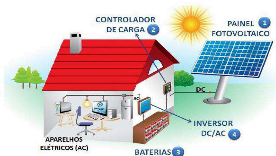
Figura 1 – Sistema isolado ( Off-grid )
