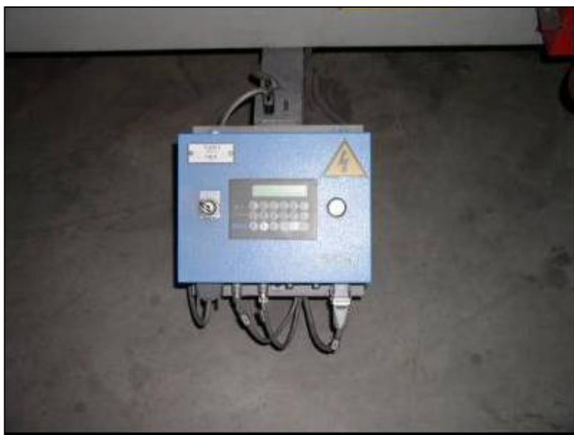
**Figura 4.8– Decodificador de Sinal Sick**
