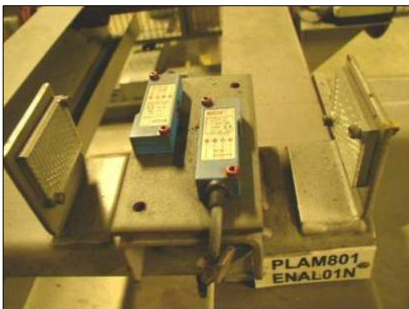
**Figura 4.6 – Sensor óptico para leitura do código do transportador**
