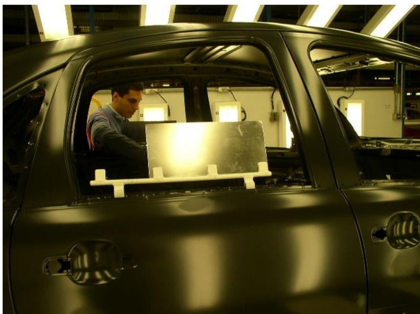
**Figura 7.3 - Montagem da placa na carroceria**
