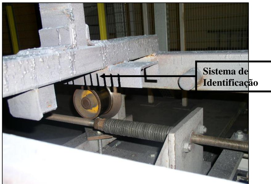
**Figura 4.7 – Sistema de Identificação da Carroceria (pente)**
