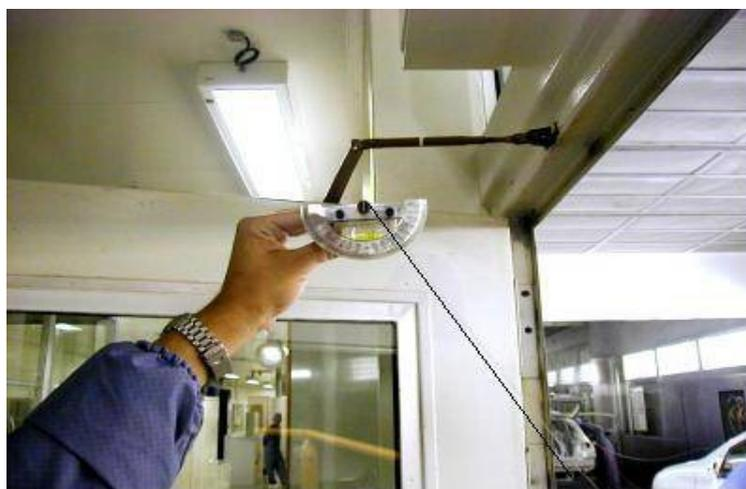
**Figura 3.6 – Medição do balanceamento do ar**
