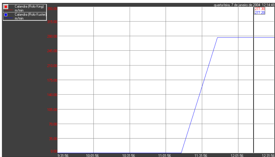
Figura 35 – Sincronismo de velocidade entre os acionamentos dos rolos superior e inferior da calandra
