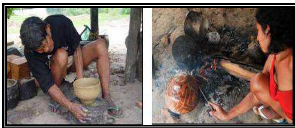
Figura 7 - Modelagem (7a) e queima de panela cerâmica (7b). Fonte: Alberto Ampuero.
