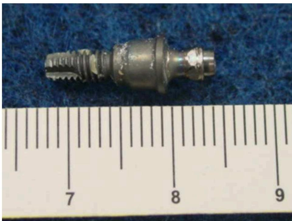
Figura 25 - Aspecto da amostra 4 (50  $\mu\text{m}$ ) após irradiação da superfície
