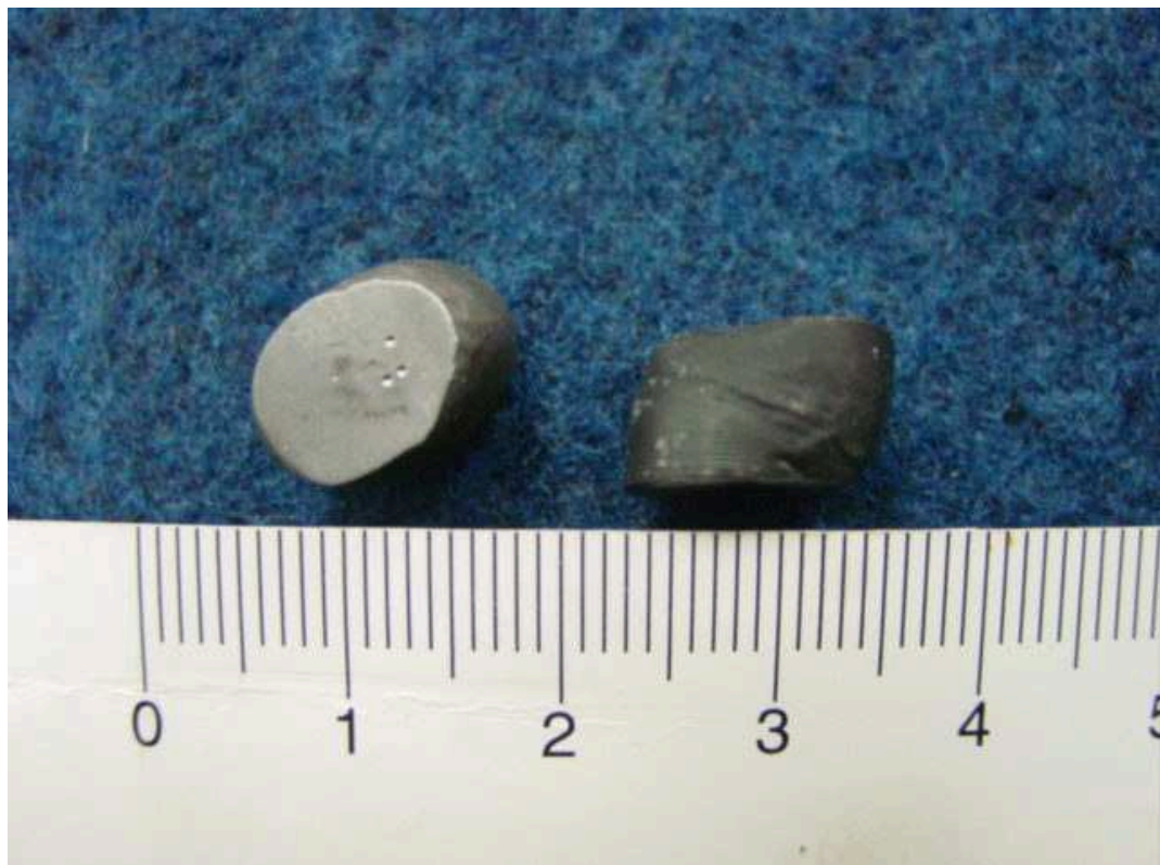
Figura 22 – Aspectos dos lingotes após simulação do forjamento
