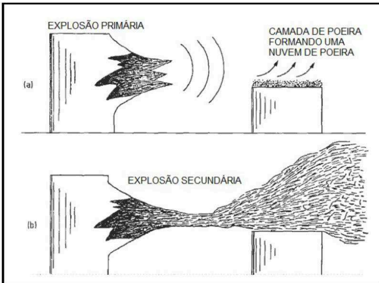
Figura 3 Esquema de uma explosão primária e secundária. (a) Esquema de uma explosão primária gerando uma onda que espalha o pó. (b) Esquema de uma explosão secundária gerada a partir de uma primária. Fonte: Eckhoff (2003) apud Silva, Janaina de Andrade (2012)
