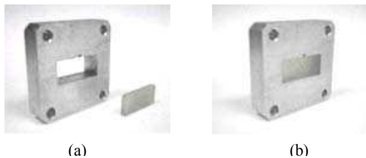
Figura 26. Suporte das amostras no sistema de guia de onda (8 – 12 GHz). (a) amostra não encaixada no suporte. (b) amostra encaixada no suporte
