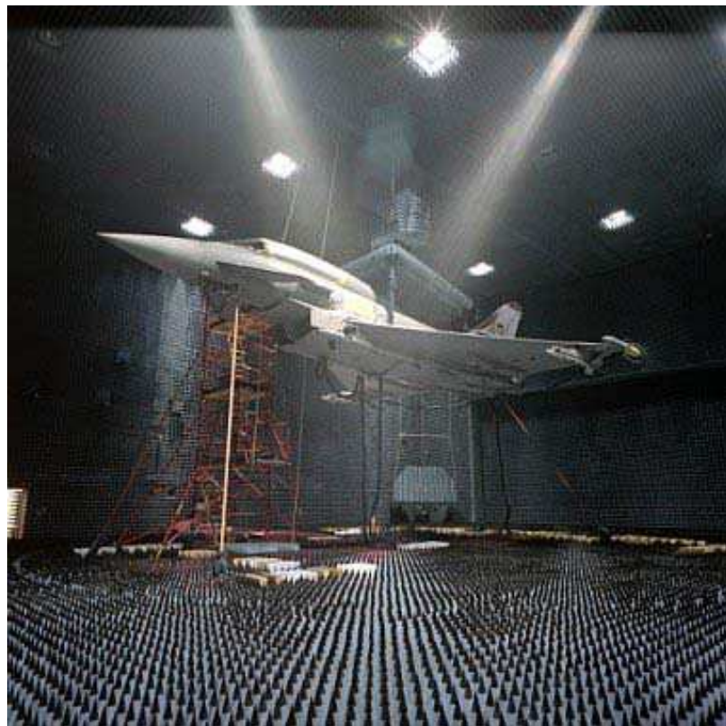
Figura 15. Câmara anecóica com absorvedores de microondas em espaço livre (AIRPOWER, 2005)
