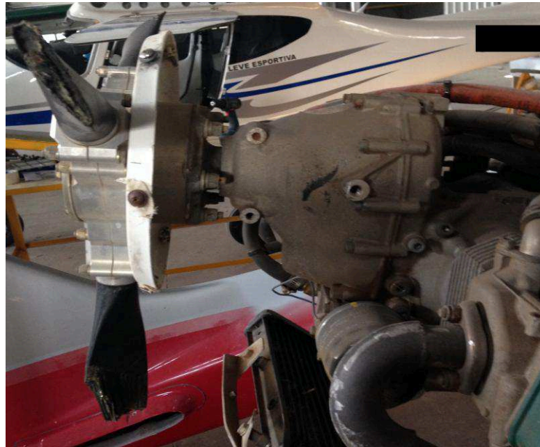
Figura 14 – Aeronave com Motor e Hélice Danificados
