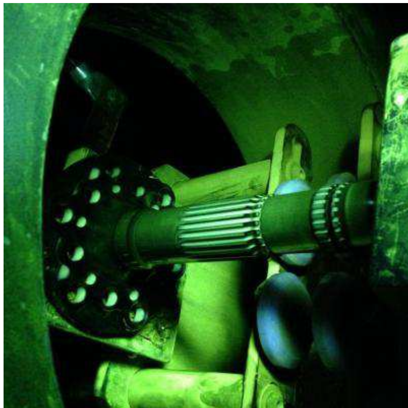
Figura 20 – Método circular por passagem de corrente elétrica – Técnica: Contato direto
