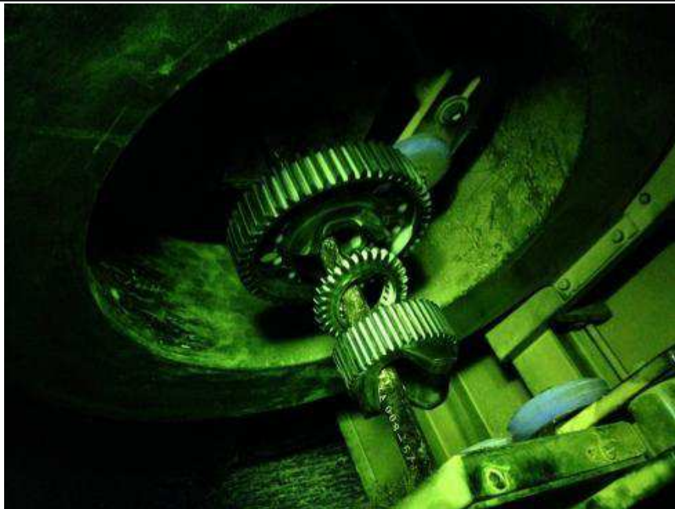
Figura 21 – Método circular por indução de campo – Técnica: Condutor central
