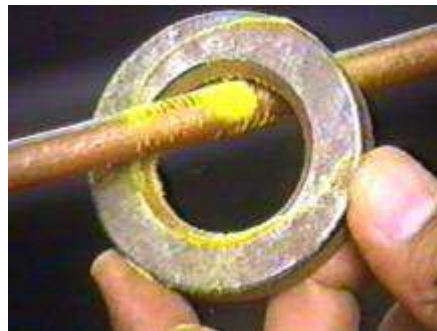
Figura 9 – Ensaio utilizando a técnica do condutor central. Fonte: ABENDI 2014
