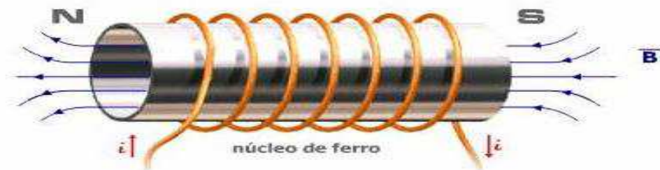
Figura 1 – Sentido do campo magnético gerado pelas bobinas. Fonte: ABENDI 2014
