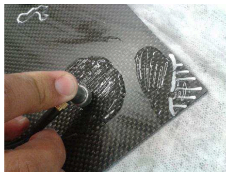
Figura 19 - Medição do CDP 2 (superfície sem defeito)
