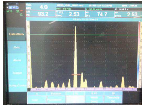
Figura 18 - Medição do CDP 2 (superfície sem defeito)
