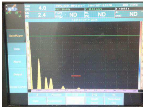
Figura 20 - Medição da delaminação no CDP 2
