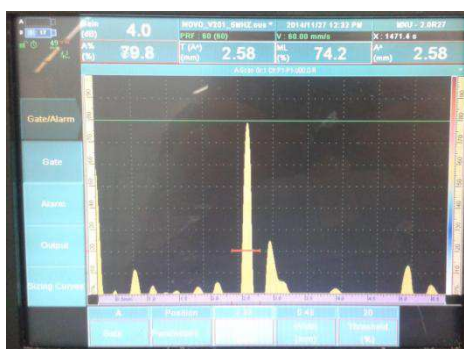
Figura 22 - Medição do CDP 2 (superfície sem defeito)
