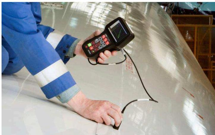
**Figura 3** – Ensaio por Correntes Parasitas aplicado na fuselagem da aeronave.
