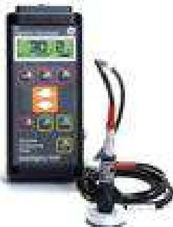
**Figura 5** – Medidor de condutividade elétrica para verificação de metais não ferrosos.
