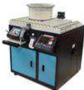
**Figura 8** – Sistema rápido e confiável de ensaios não destrutivos em rodas de aparelhos aeronáuticos.
