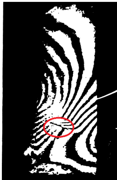
Figura 12 – Trinca em uma pá de turbina compósita, destacada na elipse em vermelho. Fonte: Adaptação de HUNG (1999).
