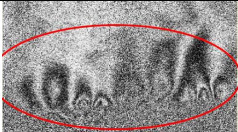
Figura 5 – Exemplo de imagem obtida em um ensaio de shearografia , com as franjas de interferência em destaque.
