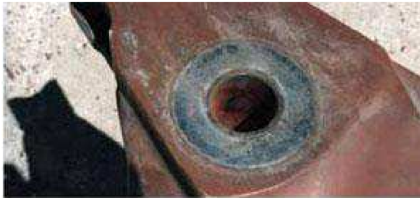
Figura 8 (A-C) - Corrosão nos componentes do helicóptero.
