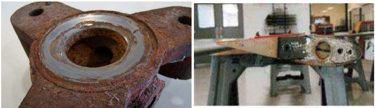
Figura 7 (A e B) – Corrosão nos componentes do helicóptero.
