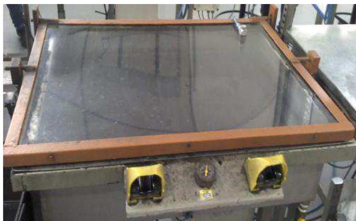
**Figura 7 – Dispositivo de estanqueidade**
