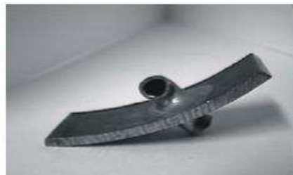
Figura 2: Brasagem entre componentes tubulares de cobre e aço.
