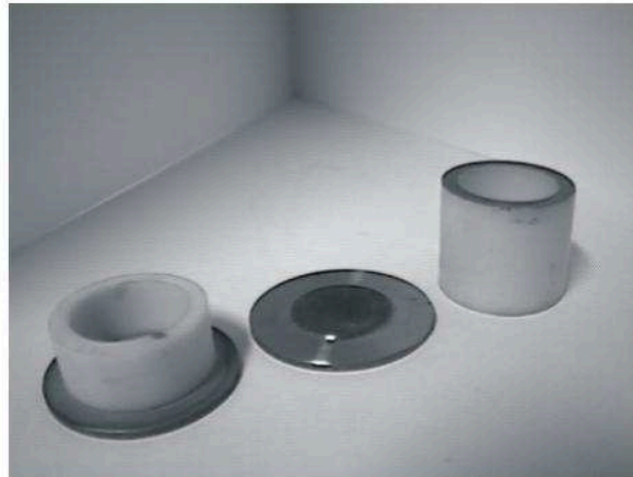
Figura 4: Brasagem entre cerâmica alumina e liga Fe-Ni-Co
