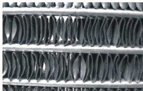
Figura 3: Brasagem de condensadores de ar condicionado automotivo.
