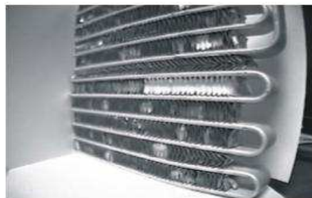
Figura 2: Brasagem entre componentes tubulares de cobre e aço.
