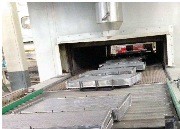
Figura 16: radiadores no processo de desengraxe.
