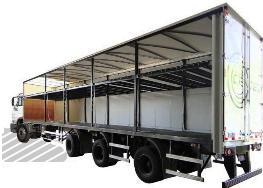
Figura 15 - Sistema double deck em caminhões
