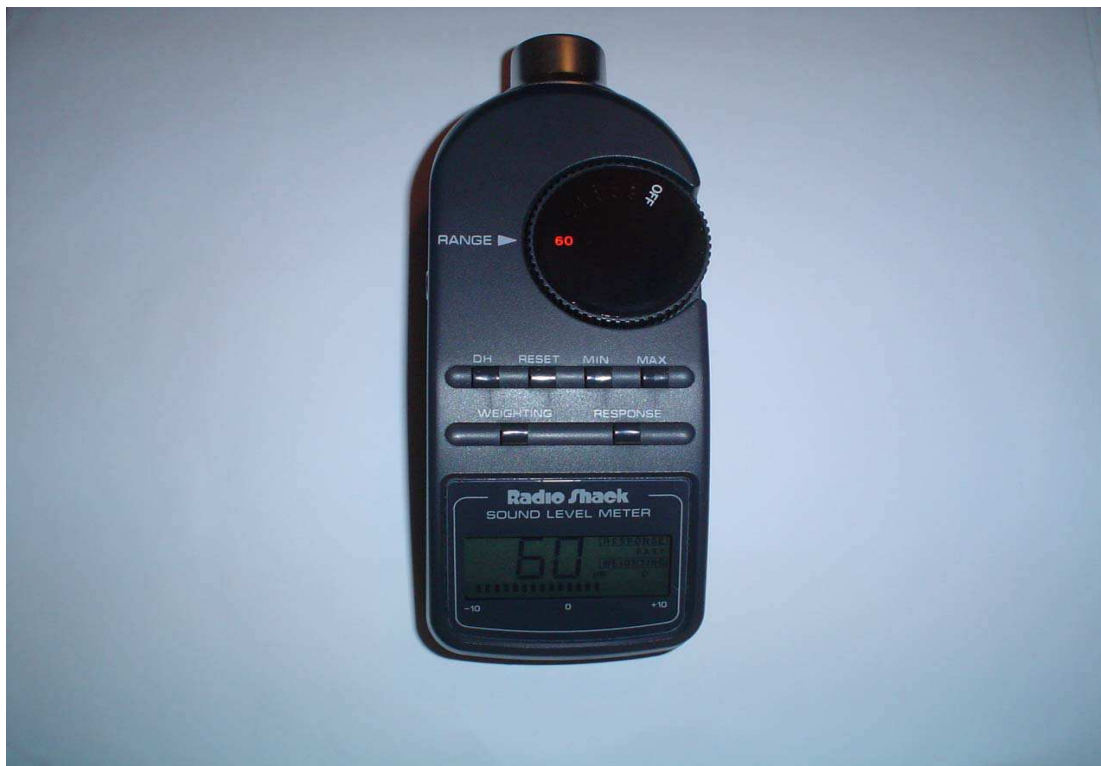
Figura 07: equipamento utilizado nas medições Digital Sound Level Meter – Radio Shack, Cat. N° 33-2055
