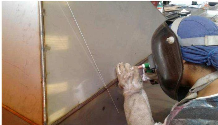
Figura 14 – Foto da execução da solda no módulo do silenciador.
