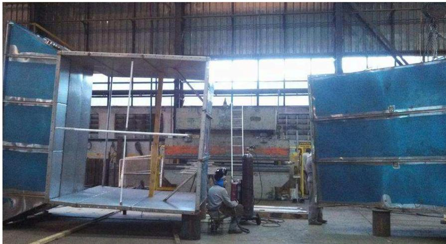
Figura 16 – Foto da execução da solda na curva do Intake.
