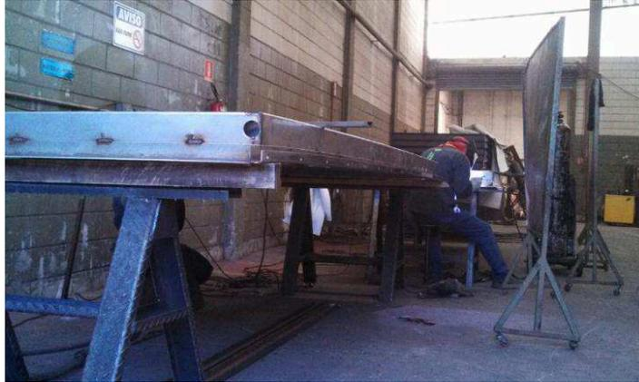
Figura 13 – Foto da execução da solda no eliminador de gotas.
