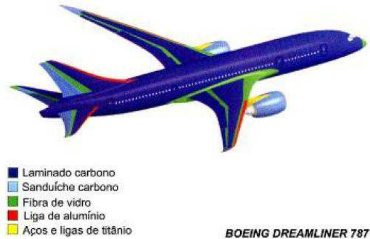
Figura 1 – Utilização de materiais de compósitos na construção da aeronave Boeing Dreamliner 787
