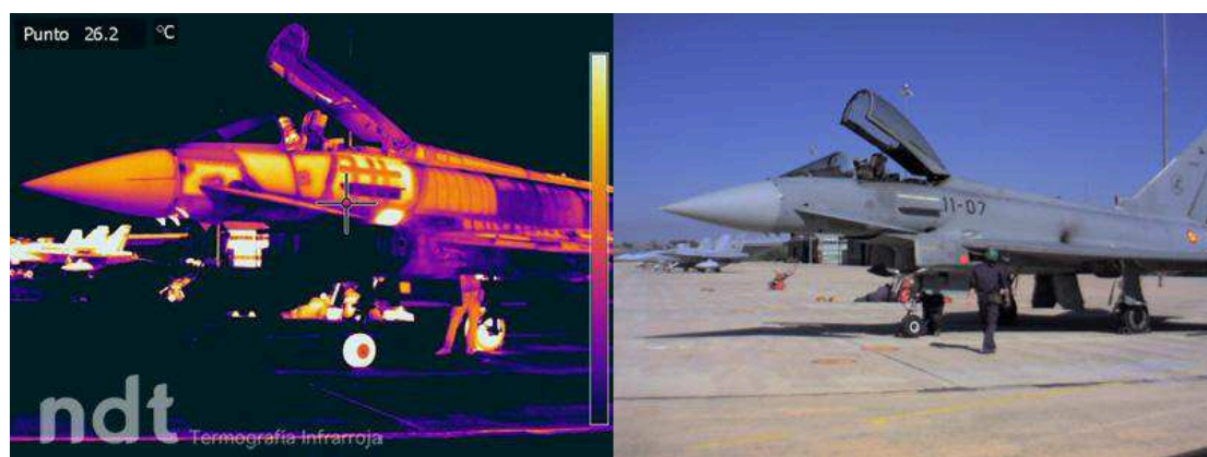
Figura 6 – Inspeção utilizando termografia
