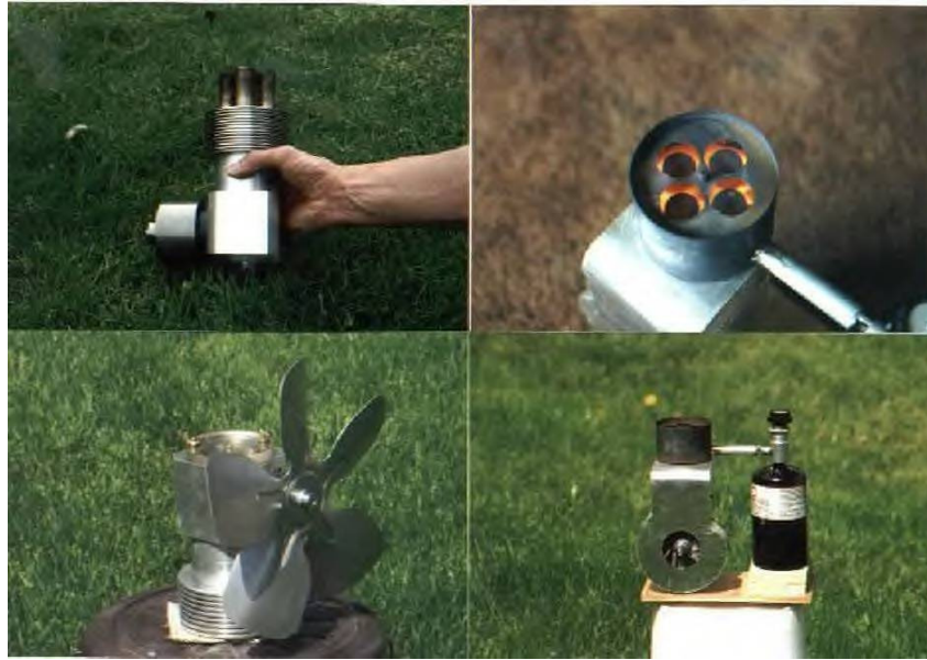
Fig. 35 – Motor Stirling montado, com queimador e cilindro de gás combustível (STEELE, 1994)
