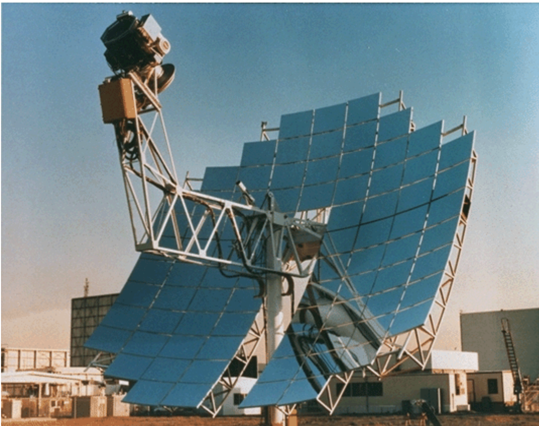
Fig. 8 – Conjunto motogerador e concentrador parabólico, Califórnia Edison, EUA (SANDIA, 2006)
