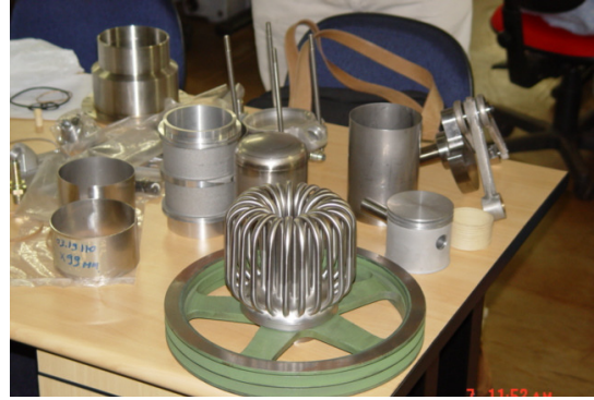
Fig. 6 - Peças fundidas (esq.) e usinadas (dir.) motor Stirling ST 05 G 350 - 500 Watt
