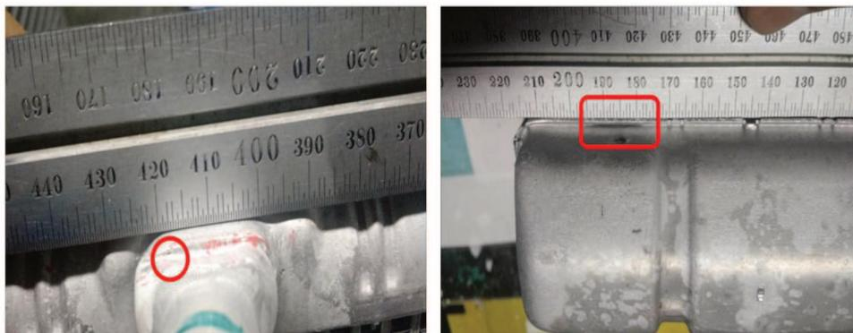
Figura 12 – (A) Gap entre tubo e cabeceira (B) Gap entre caixa e cabeceira
