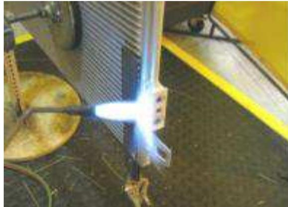
Figura 16 - Brasagem manual com maçarico
