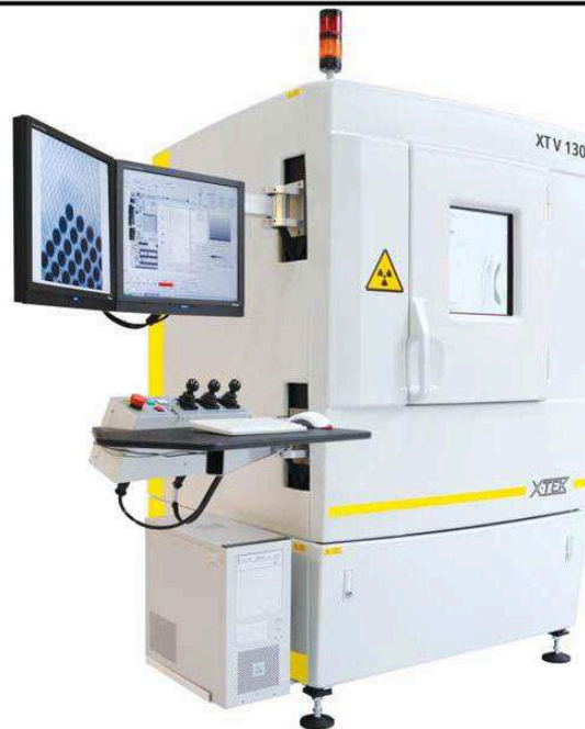
Figura 14: Estação de raios X de placas eletrônicas
