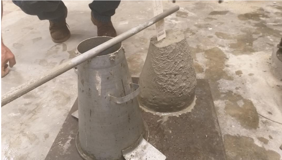
Figura 4 - Medição do abatimento do tronco de cone
