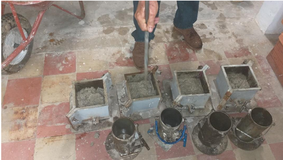
Figura 9 - Moldagem de corpos de prova cúbicos
