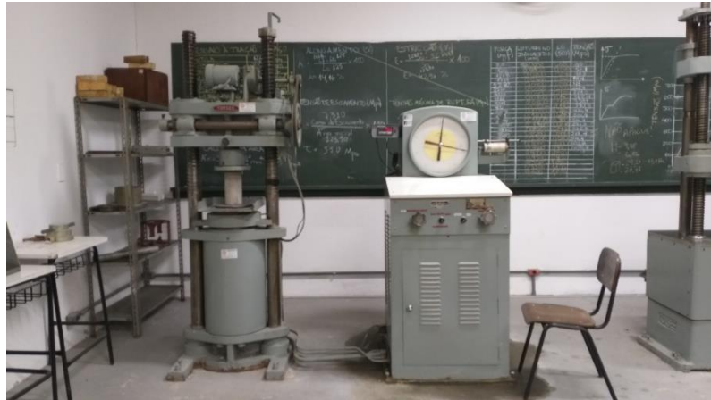
Figura 14 - Máquina de ensaio de resistência à compressão axial
