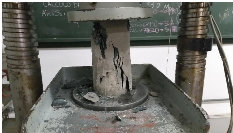
Figura 15 - Rompimento de corpo de prova cilíndrico
