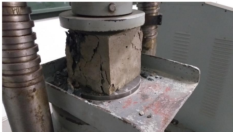
Figura 3 - Rompimento de corpo de prova cúbico
