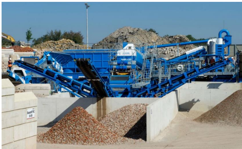
Figura 4 – Britagem e Separação de agregados
