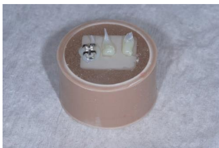
Figura 3: colagem do braquete na superfície da amostra.
