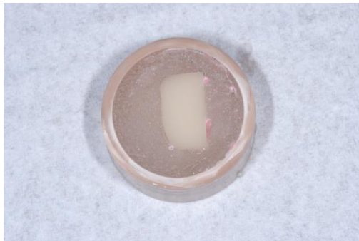
Figura 1: Amostra do material restaurador embutido em resina acrílica.
