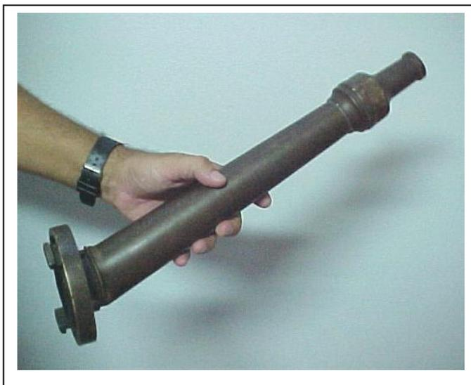
Figura 21 Esguicho agulheta DN25, amassado à perda de controle da combate a incêndio pelos brigadistas, durante um incêndio em indústria.
