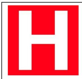
Figura 28 Sinalização de hidrante de incêndio.
