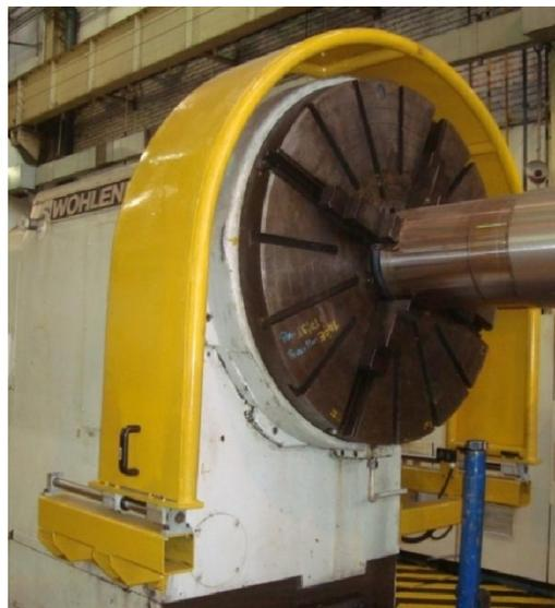
Figura 11 Carenagem da placa contra risco de projeção de ferramenta
