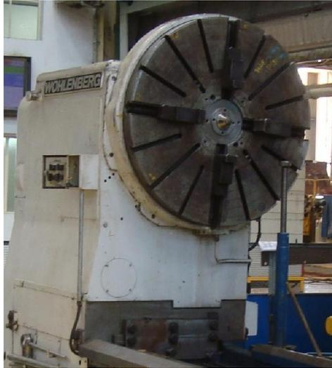
Figura 10 Placa com risco de projeção de ferramenta
