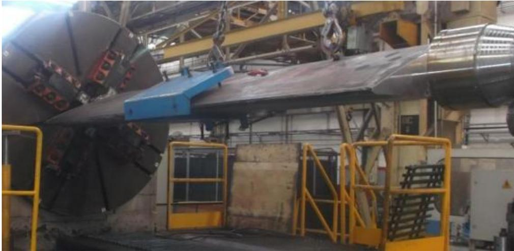
Figura 08 Montagem da palheta no torno
