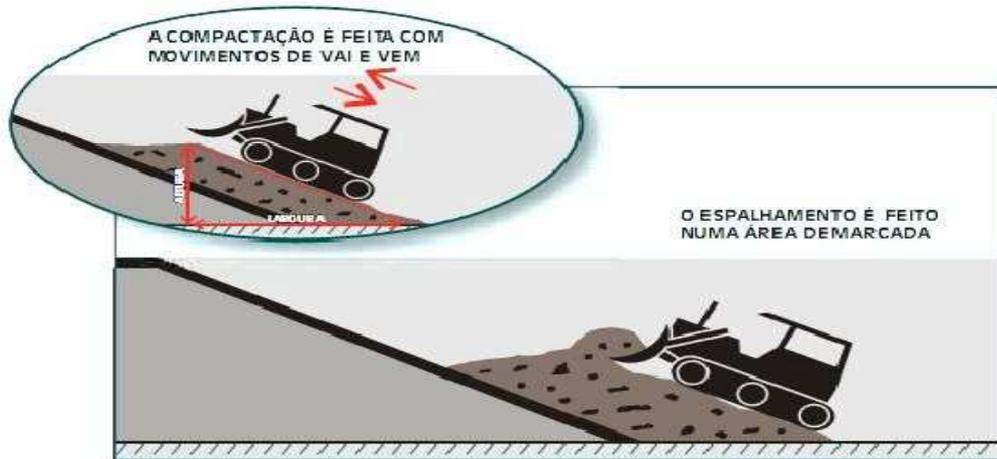
Figura 3 Modo de compactação do resíduo dentro da célula de disposição
