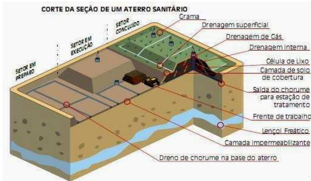
Figura 1 Corte de seção de Um Aterro sanitário
