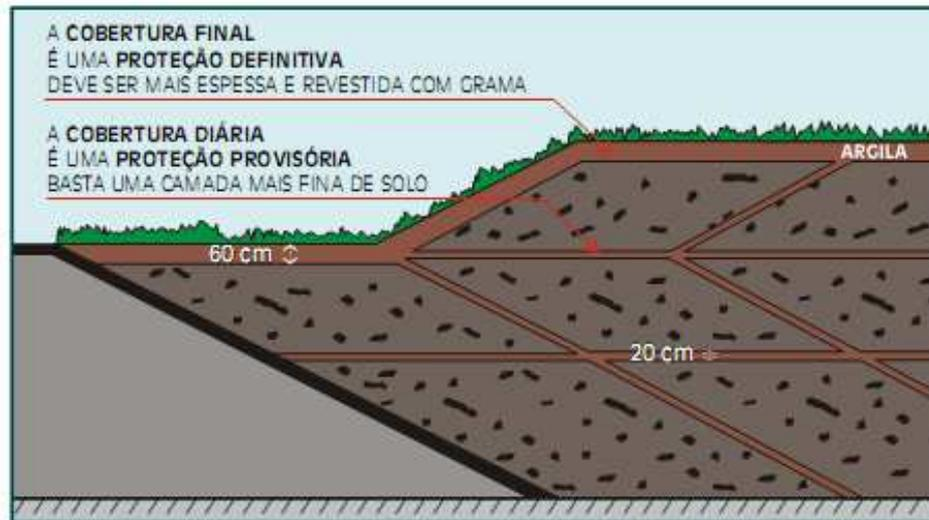
Figura 4 Estrutura final das células de resíduos no Aterro sanitário
