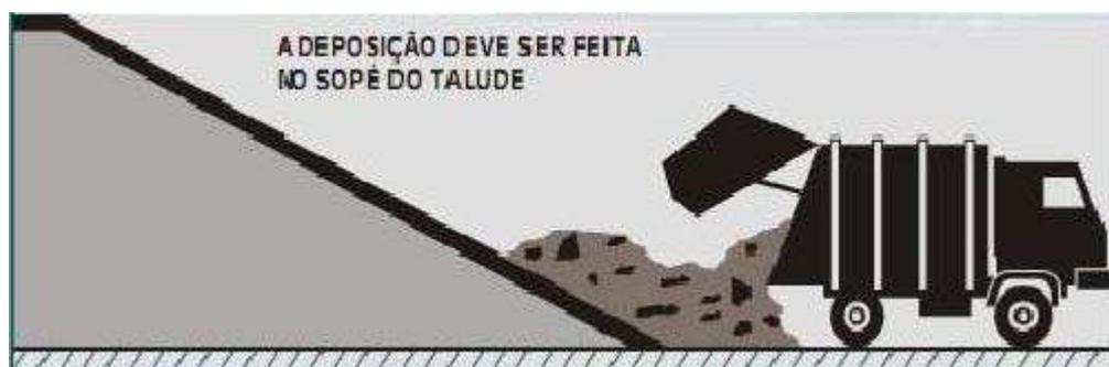
Figura 2 Modo de operação de descarga do resíduo na célula de disposição
