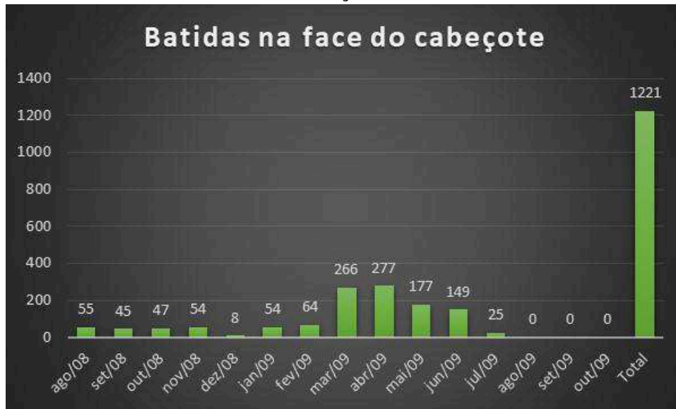
Grafico 1 - Riscos e batidas na face do tensionador apresentou redução significativa no Indicador de Desempenho da linha de usinagem de cabeçotes
