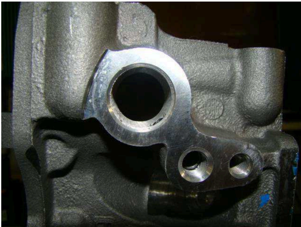
Figura 6 - Tensionador da Corrente sem o Plug Protetor
