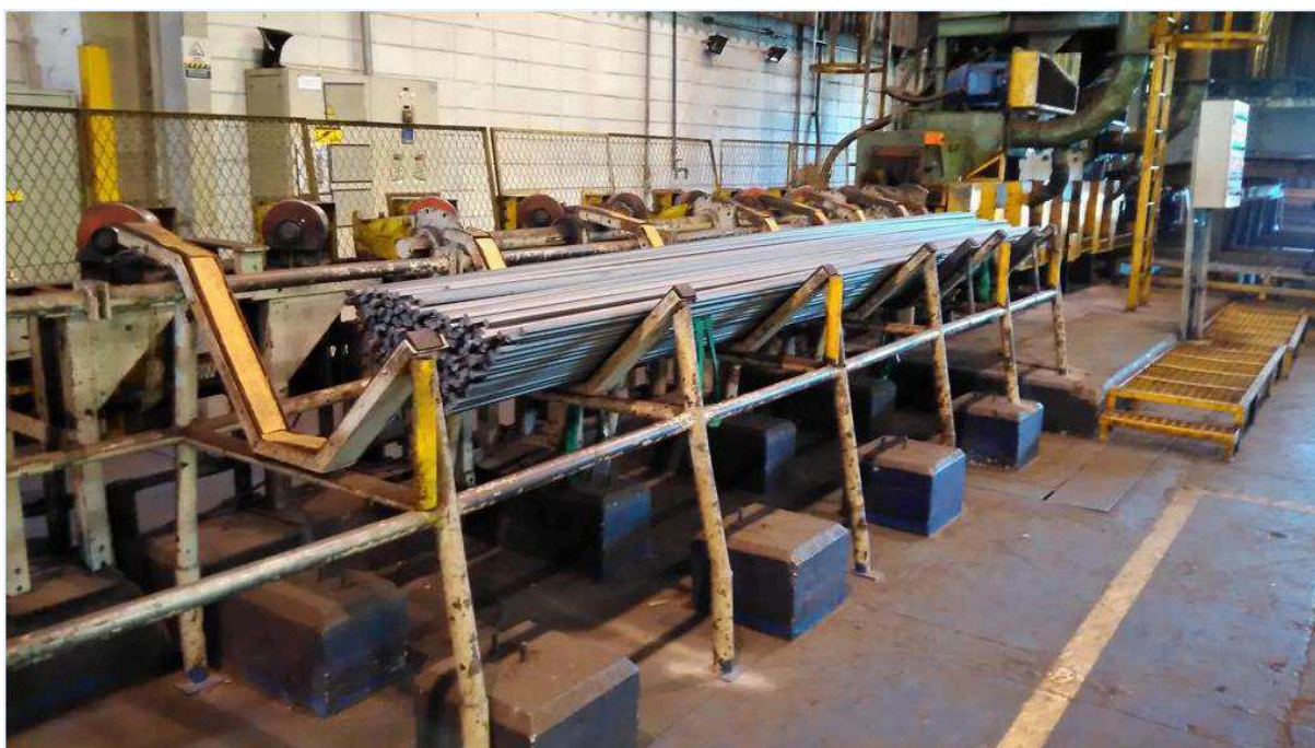
Figura 2 - Sistema de decapagem e “coxo” de saída.
