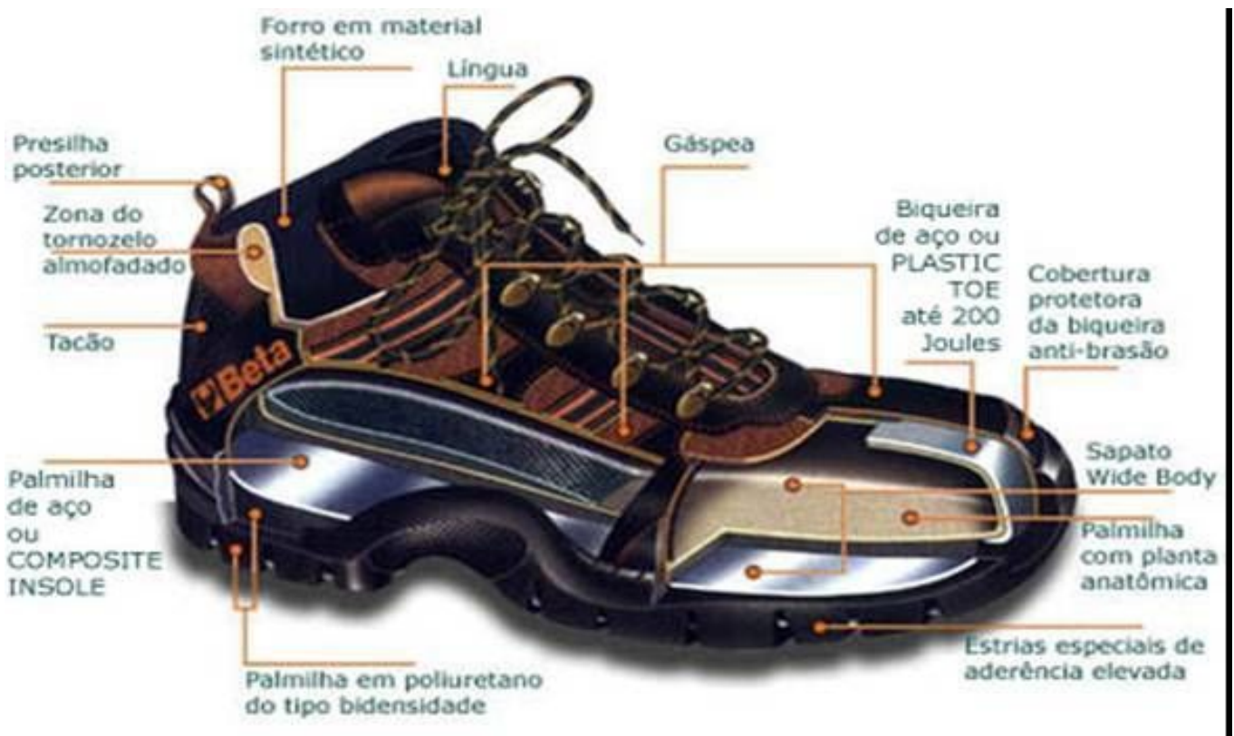
Figura 5 - Partes de calçado de segurança normal Fonte: www.costagarcia , acesso 2009
