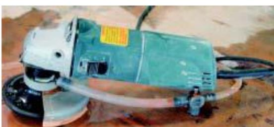
**Figura 07-** Lixadeira elétrica com alimentação contínua de água
