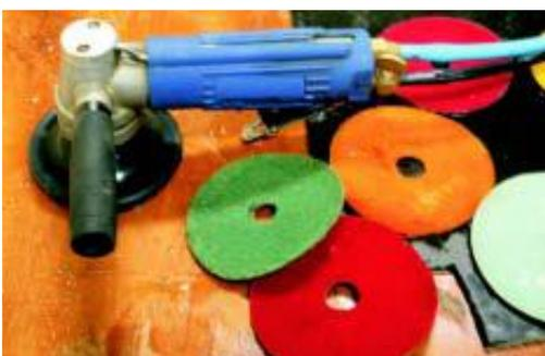
**Figura 04 -** Lixadeira pneumática com acessório
