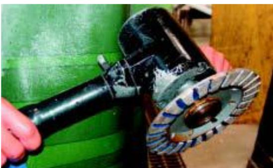
**Figura 05-** Lixadeira pneumática com disco de desbaste
