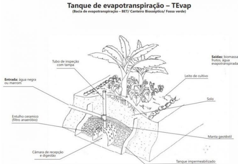
Figura 7: Sistema de tratamento de água negra
