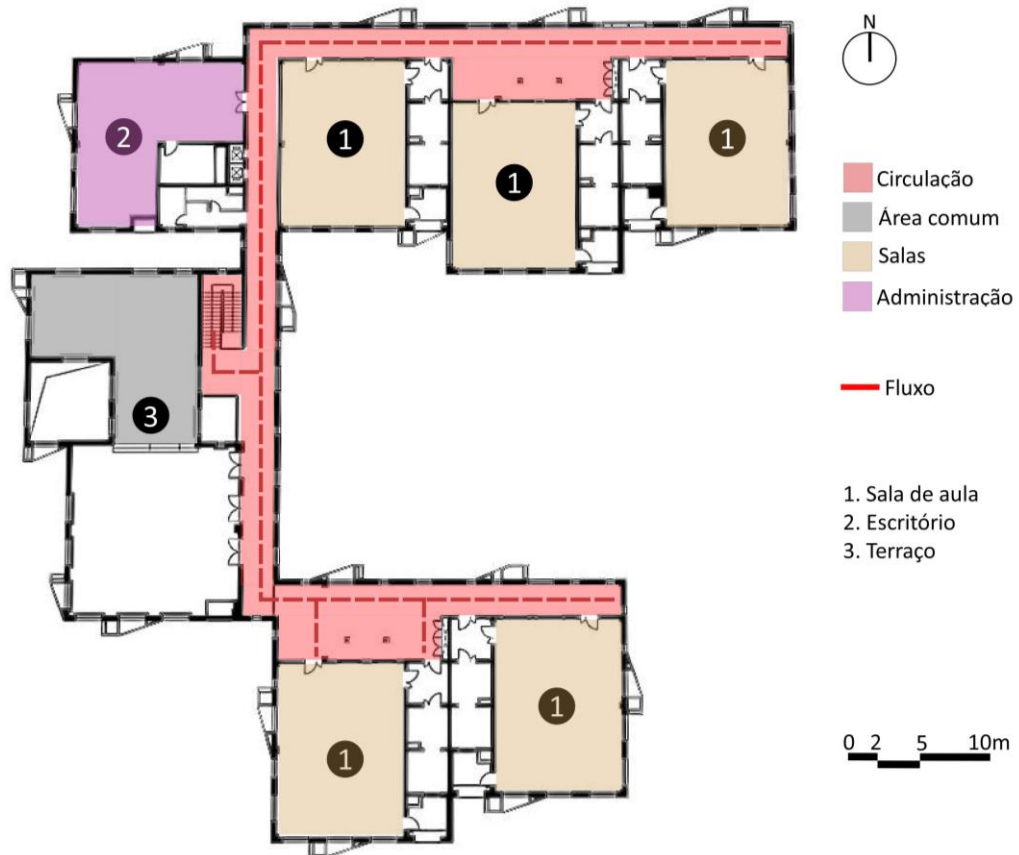
Figura 13: Planta do segundo pavimento
