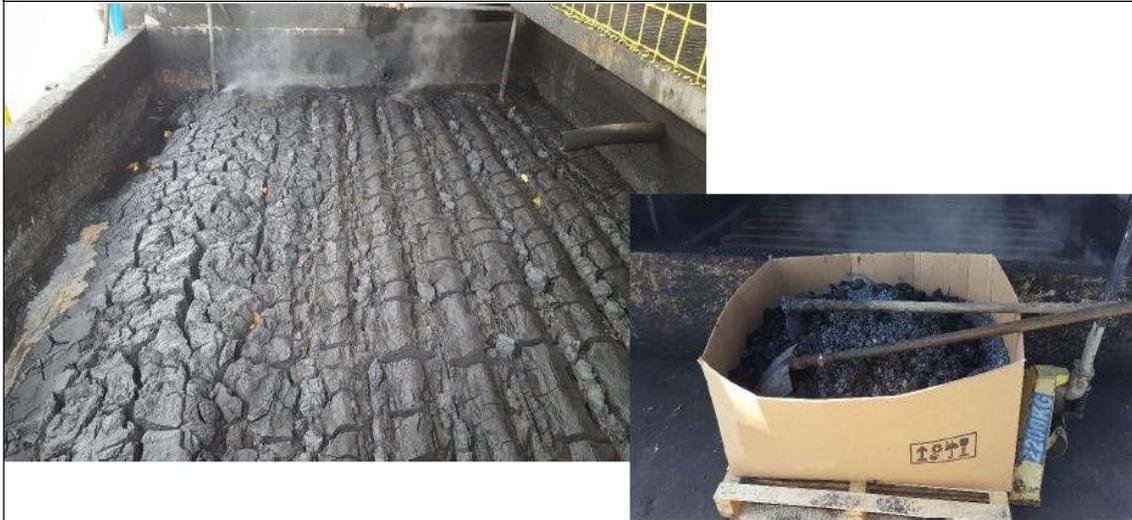
Figura 3 Lodo seco e acondicionado em caixas
