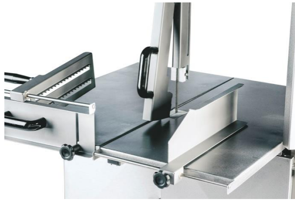
Figura 8 Detalhe da mesa de corte, mesa deslizante, braço articulado e limitador de fatia Fonte: C.A.F., 2017
