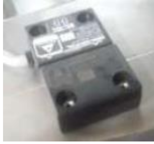
Figura 7 Sensor tipo chave magnética de abertura das portas das polias de transmissão Fonte: C.A.F., 2017
