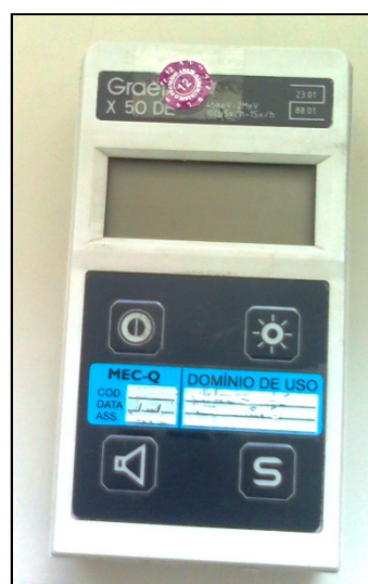
Figura 12 Exemplo de monitor individual com alarme
