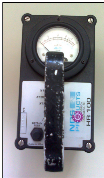
Figura 11 Exemplo de medidor de radiação portátil
