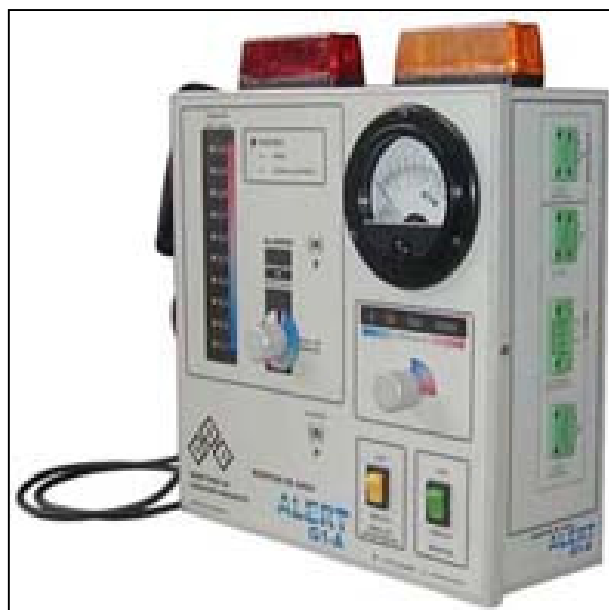
Figura 13 Exemplo monitor de radiação permanentemente com alarme sonoro e visual
