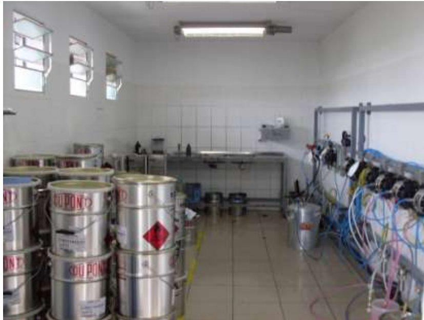
Figura 3 Sala de preparação de tintas com bombas de distribuição Fonte: A autora, 2009.
