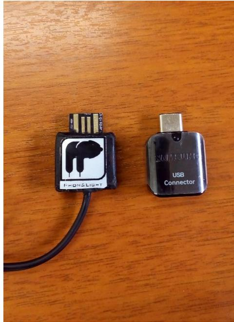
Figura 9 - Cabo USB e adaptador OTG.
