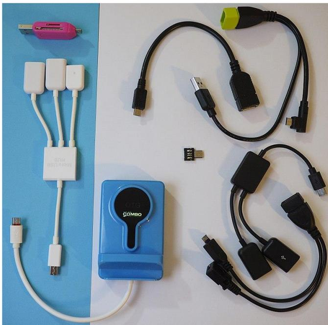
Figura 4 - Principais modelos de adaptadores OTG.
