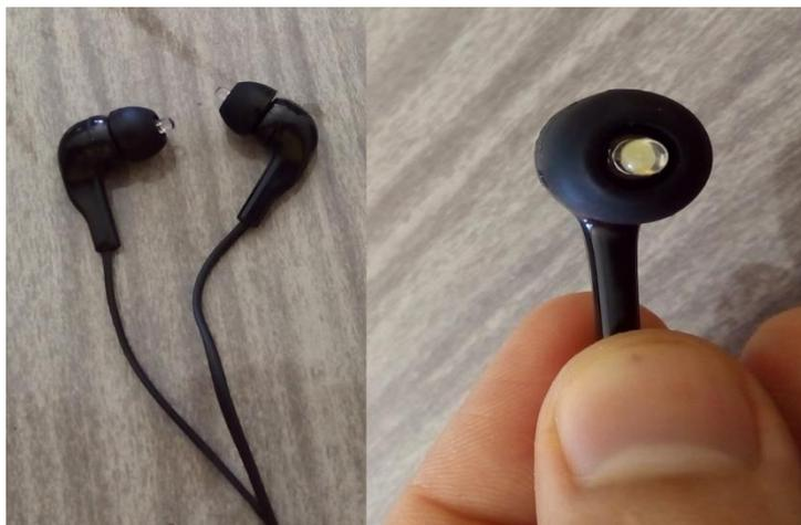
*Figura 7 - Visão lateral e frontal do protótipo dos fones fotoemissores.*
