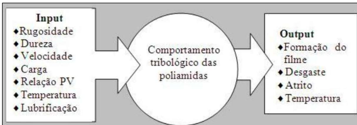
Figura 36 - Representação esquemática dos parâmetros que influenciam o comportamento das poliamidas e os parâmetros que podem resultar do respectivo sistema tribológico
