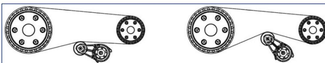
Figura 1 - Mecanismo de tensionamento. Nos momentos em que a correia está tracionada, o esticador resiste ao movimento. Quando a correia afrouxa, o esticador restitui o movimento, esticando-a
