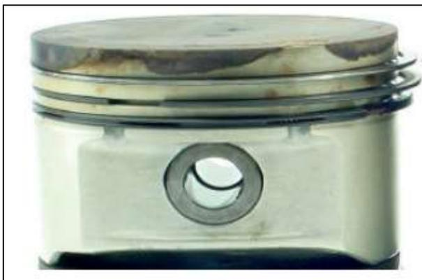
Figura 18 - Conjunto de anéis montados sobre o pistão
