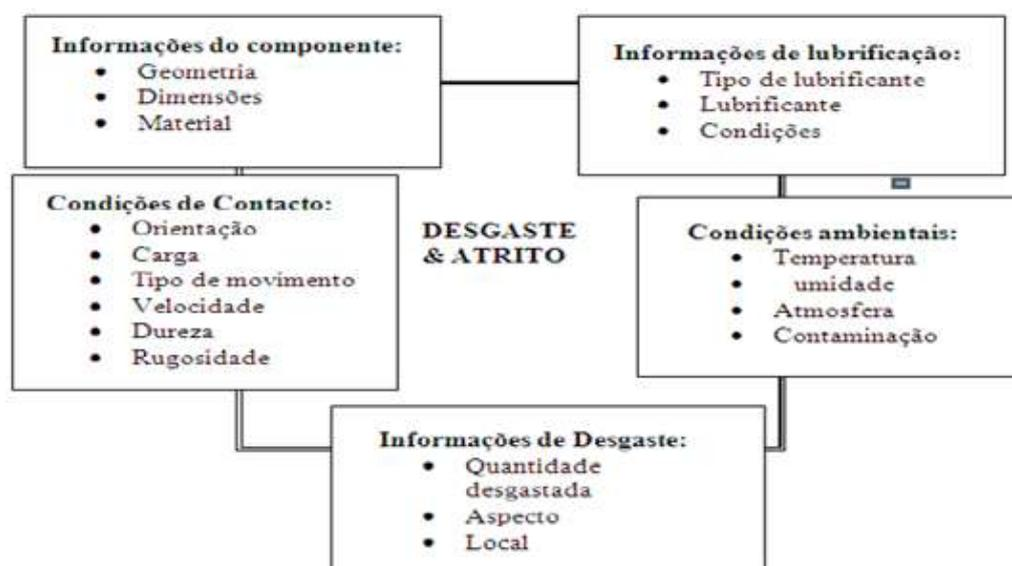
Figura 5 - Representação esquemática de alguns dos parâmetros relevantes que condicionam o comportamento ao desgaste e ao atrito de um material
