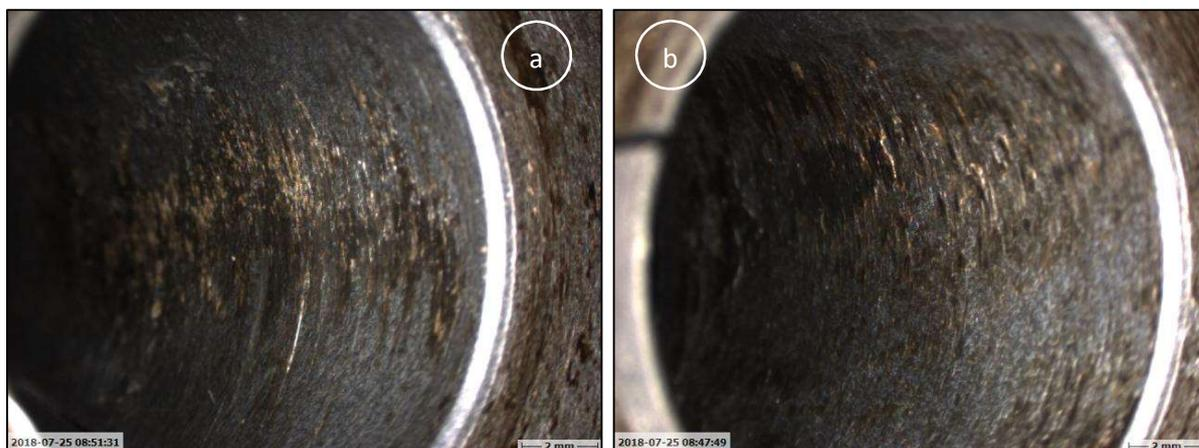
Figura 113 – Fotomacrografia. Aumento 20X. Observa-se a região de contato da bucha com o eixo. a) amostra 5 b) amostra 16
