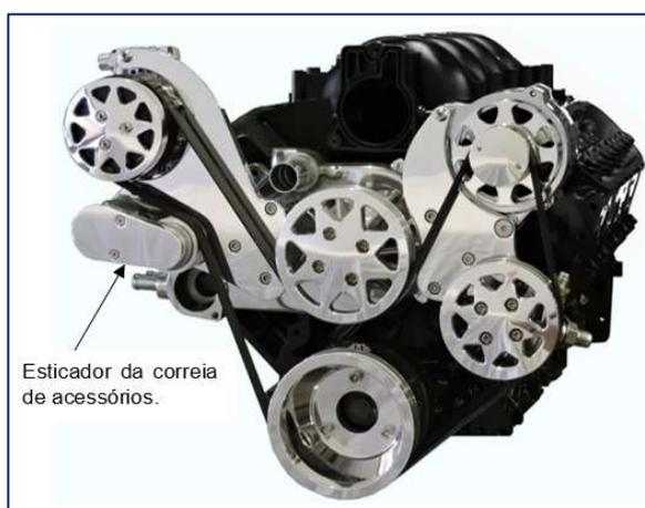
Figura 2 - Exemplo de um sistema de transmissão por correia de acessórios assistido por um esticador
