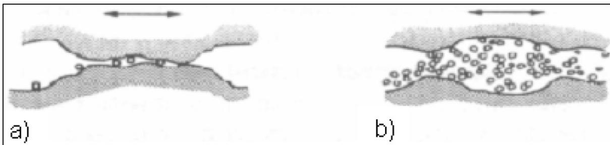
Figura 28 - a) Desgaste corrosivo - início da reação química entre as superfícies; b) Desgaste das superfícies pelo mecanismo de corrosão
