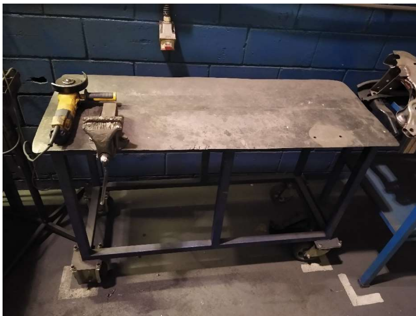
Figura 10 - Bancada com morsa e lixadeira para cortar os experimentos
