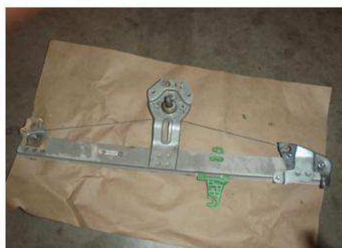
Figura 24: Supressão máquina levanta vidro
