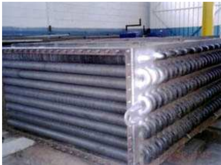
Figura 19 – Foto de um modelo de economizador para uso em caldeiras, fabricado pela Heatmec Indústria Metalúrgica Ltda (HEATMEC, 2010)
