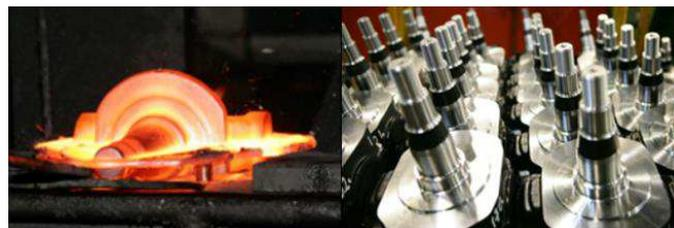
Figura 9- Manga de eixo sendo forjada e usinada.
