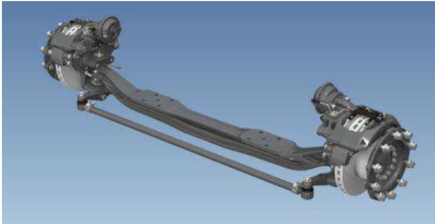
**Figura 4- Eixo direcional com freio a disco.**
