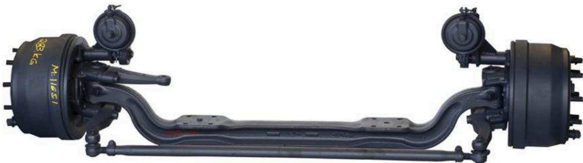
**Figura 1 - Eixo Dianteiro direcional com cubo de roda e tambor.**
