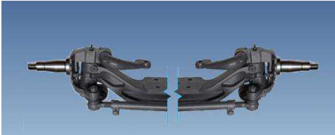
**Figura 2 – Pontas de eixo cônicas.**
