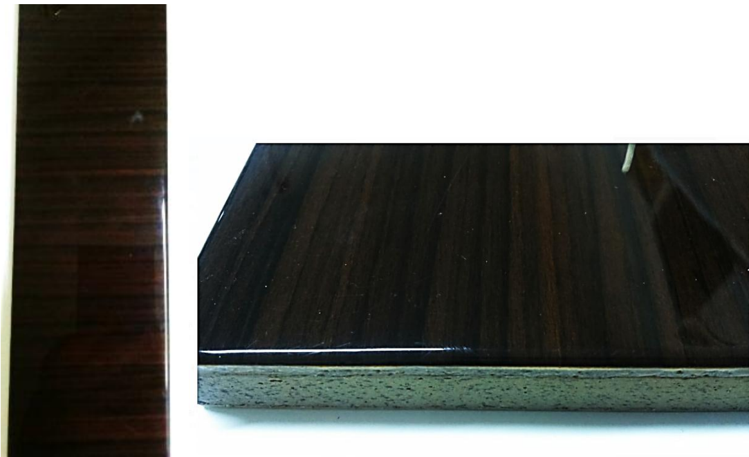
Figura 28: amostra de Wood Veneer da indústria aeronáutica submetida ao teste de UV para avaliar o verniz
