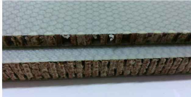
Figura 20: amostra de honeycomb sem resina de \frac{1}{2} e \frac{1}{4} de polegada de fibra de vidro
