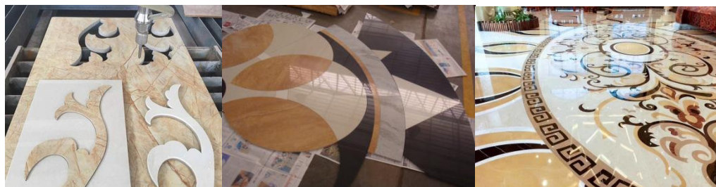
Figura 24: stone floor : corte realizado com máquina de corte de jato d'água
