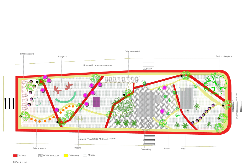
Figura 35 – Implantação: calçamento da área
