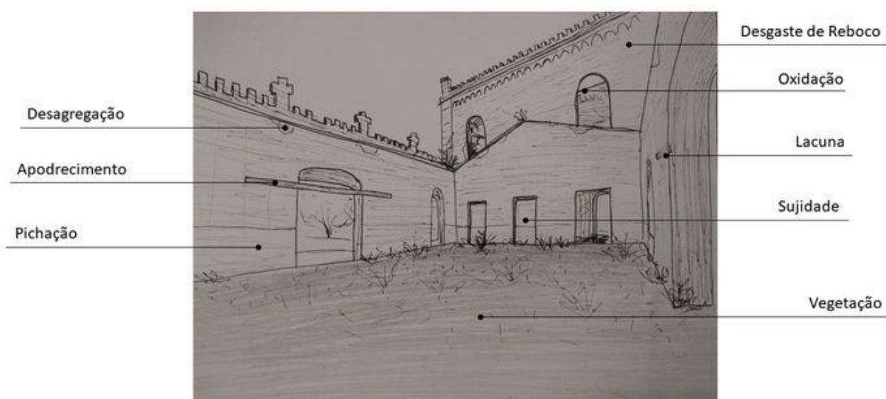
Figura 58 - Croqui para Deterioro - Estação Ferroviária
