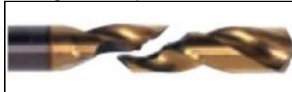
Figura 21- quebra da broca
