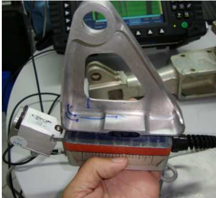
Figura 53 – Ensaio por phased array no adaptador
