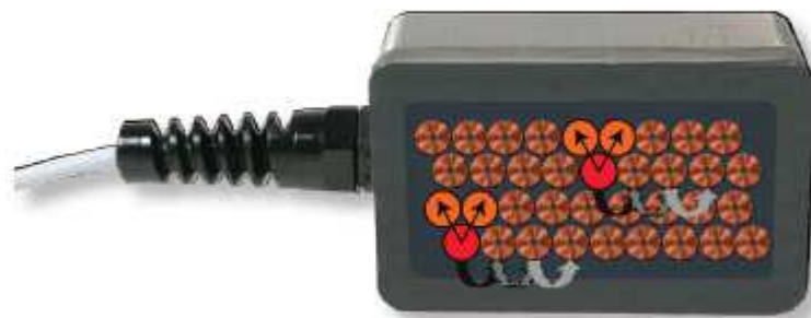
Figura 34 – Sonda com o efeito multiplexador (GE, 2009)
