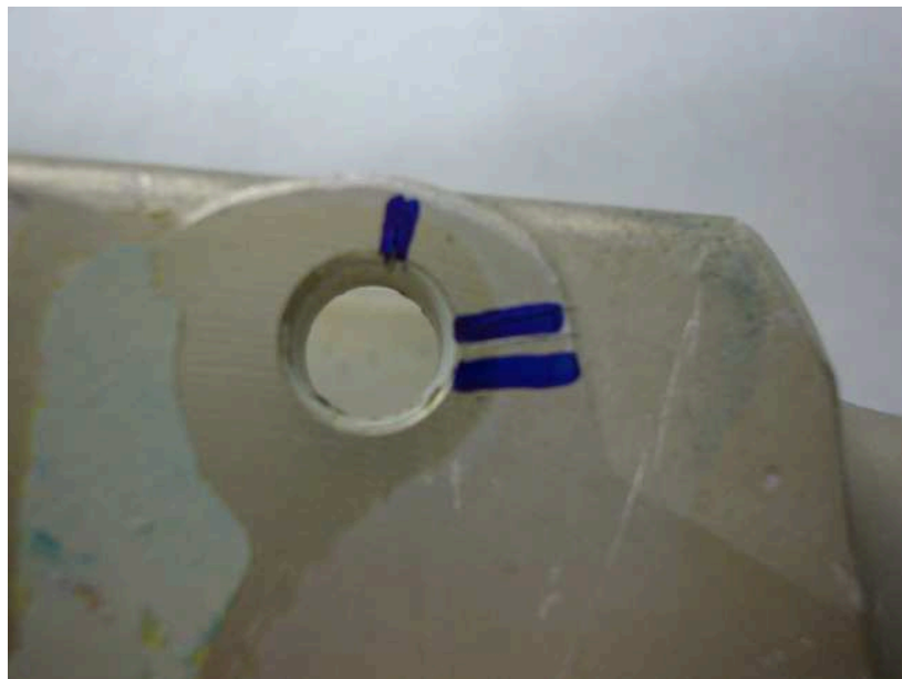
Figura 58 – Localização das trincas no furo do trem de pouso
