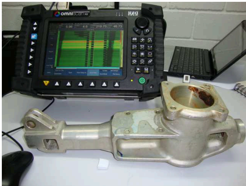
Figura 61 – Resultado da representação das trincas na tela do equipamento
