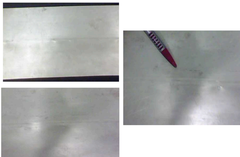
Figura 71 – Corpo de prova FSW, com as descontinuidades
