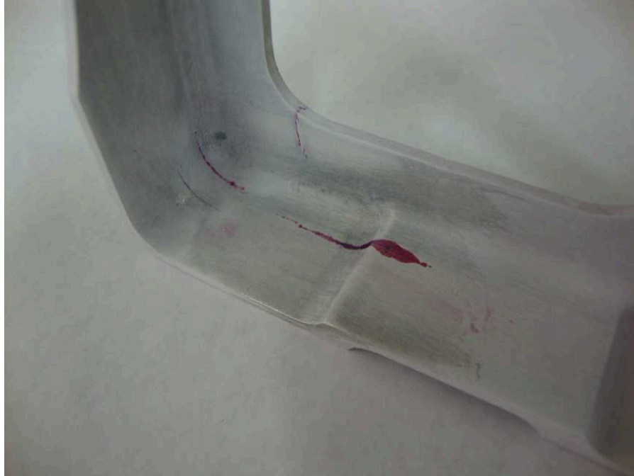
Figura 51 – Trincas detectadas pelo ensaio por líquido penetrante
