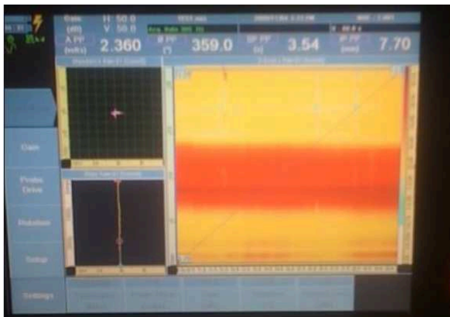
Figura 72 – Indicação das descontinuidades na tela do equipamento.
