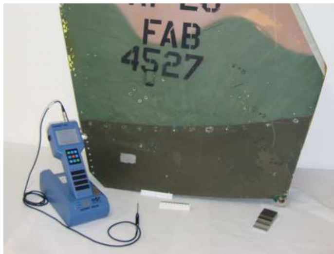
Figura 63 – Equipamento, sonda e padrão do ensaio da empena vertical
