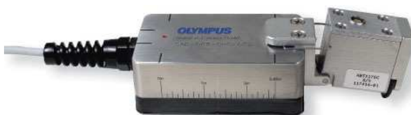
Figura 64 – Sonda array com encoder , utilizada para o ensaio (OLYMPUS, 2008)
