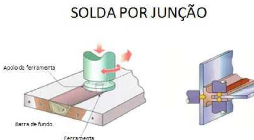
Figura 69 – Processo de solda por junção (MENDEZ; EAGAR, 2002)
