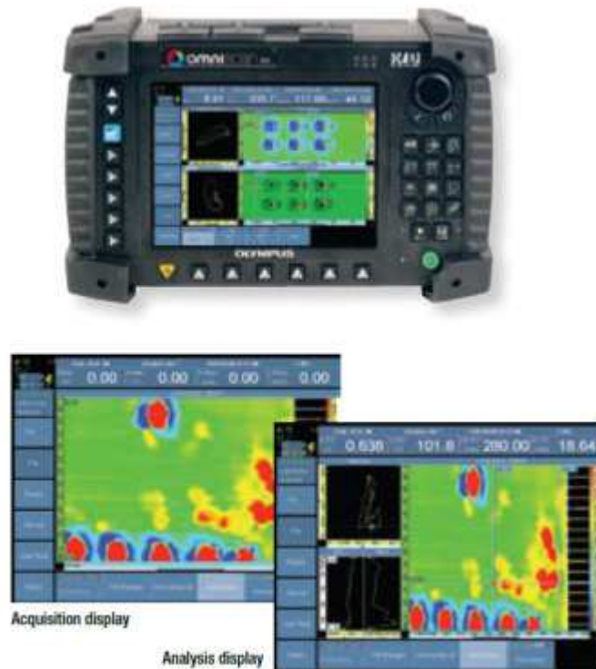
Figura 39 - Equipamento com a imagem das indicações de corrosões (LAMARRE; GOLDBERGER, 2007)
