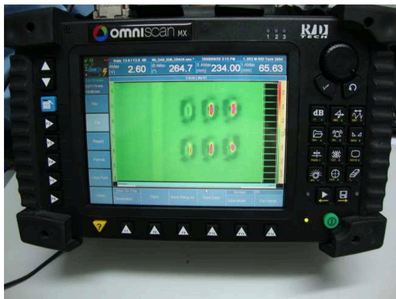
Figura 65 – Equipamento phased array com a indicação dos rebites
