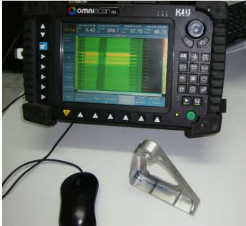
Figura 54 – Ensaio do adaptador, com a representação das trincas na tela
