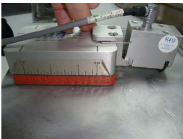
Figura 68 – Ensaio phased array na empena do foguete
