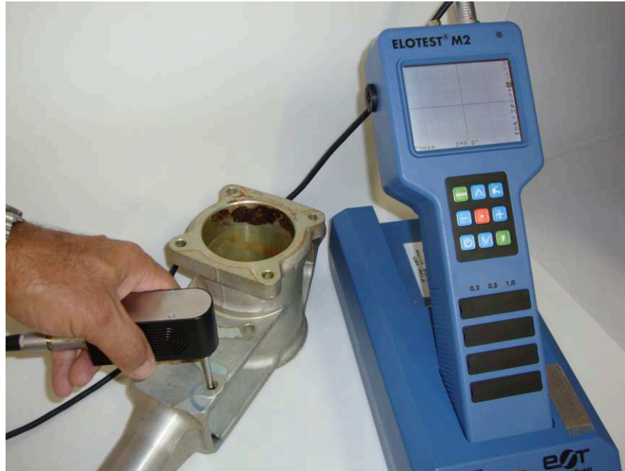
Figura 57 – Utilização da sonda rotativa no ensaio dos furos
