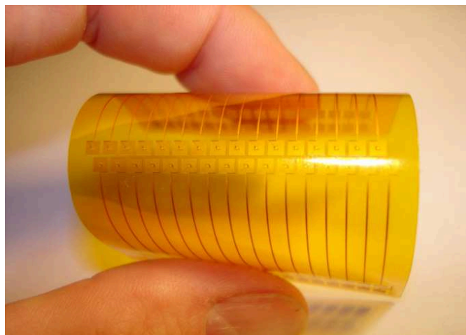
Figura 41 - Sonda flexível array (GE, 2009)
